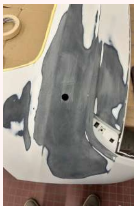
Bumper met dichtgelaste scheur
